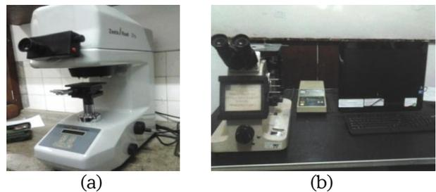
Gambar 7. (a) Alat microhardness tester dan (b) mikroskop optik.
